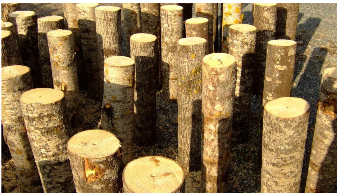
Figur 3: Fersk osp felles og kappes i 1 m lange eksperiment-stokker. Eksperiment-stokkene utstyres med et hull der armeringsjern på 1 m plasseres slik at de stikker halvveis ut av stokken. Når stokken så snus opp-ned, vil armeringsjernet bidra til å stabilisere stokken slik at den står støtt. Nederst eksperiment-stokker med ferdige borehull, klare til utplassering. – Fresh aspens are felled and cut in 1 m long experimental logs. The experimental logs are equipped with a hole in which 1 m rebar is placed, with half the length sticking out of the log. When the log is turned around the rebar contributes to stabilize the log in a steady position. Below, experimental logs with holes, ready to be placed out. Foto/Photo: AS-T
